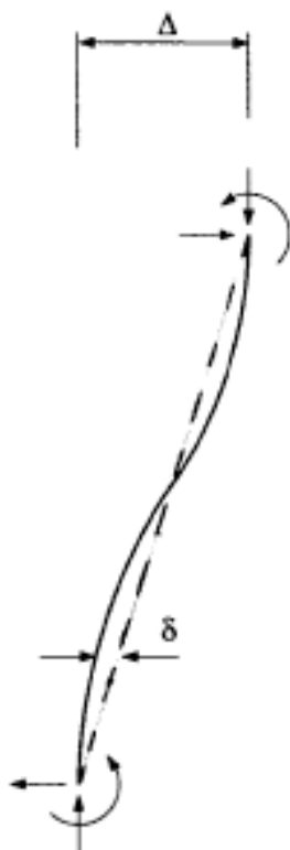
Fig. 2.26. Efectul local P- \delta și cel global P- \Delta .
