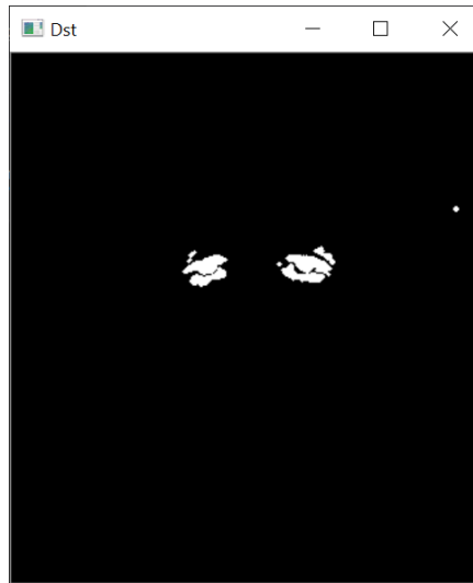
Imagine diferenta dupa aplicarea filterlor morfologice (ex: eroziune 1x + dilatare 1x cu nucleu de 3x3)
