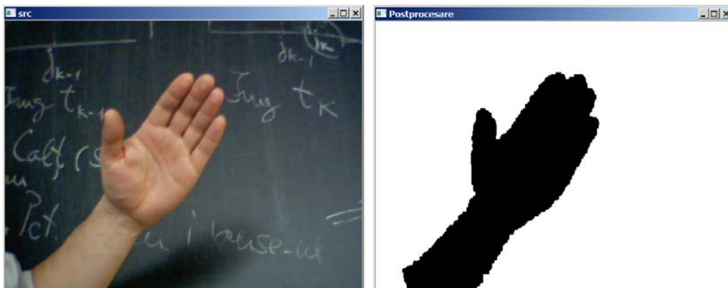
Fig. 3.5. Rezultatul dupa postprocesare cu operatii morfologice cu element structural patrat de 3x3: 2 x dilatari + 4x eroziuni + 2x dilatari (pixelii de obiect sunt negri).
