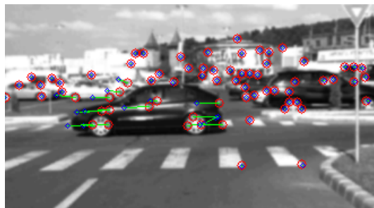
Fig. 7.2. Afisarea rezultatelor estimarii campului de miscare obtinut prin metoda LK piramidala pentru un scenariu cu un vehicul care traverseaza o intersectie de la dreapta la stanga.
