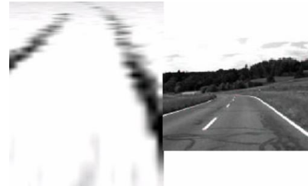
Reflectivitatea RADAR 24GHz (SRR) / 77 (LRR)
