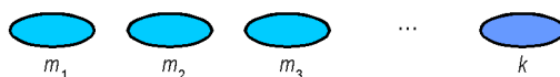
Figura 5.18. RAID 3 și RAID 4: Fișierul M = m_1, \dots, m_n este distribuit pe n discuri (la nivel de biți la RAID 3, la nivel de blocuri la RAID 4). Discul de paritate ( k ) păstrează paritatea înregistrărilor.
