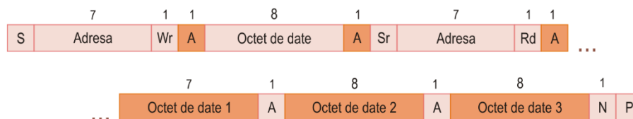
Figura 3.22. Ciclul de scriere, citire și start conversie al circuitului LTC2481.
