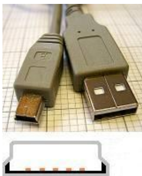
Figura 4.9. Mufă USB de tip mini-B alăturată cu o mufă de tip A.
