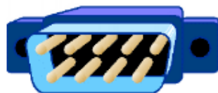
Figura 1.5. Conectorul DB-9 utilizat pentru porturile seriale ale calculatoarelor IBM PC.
