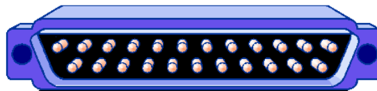
Figura 1.4. Conectorul DB-25 utilizat pentru porturile seriale ale calculatoarelor personale din generațiile anterioare.
