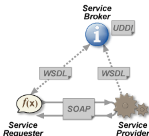
Figura 3.5 Modelul de funcționare a unui serviciu web
