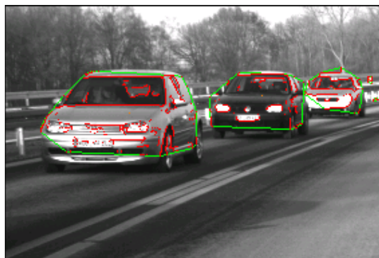
Fig. 4.2.9. Exemplu de model poligonal în spațiul imaginii.
