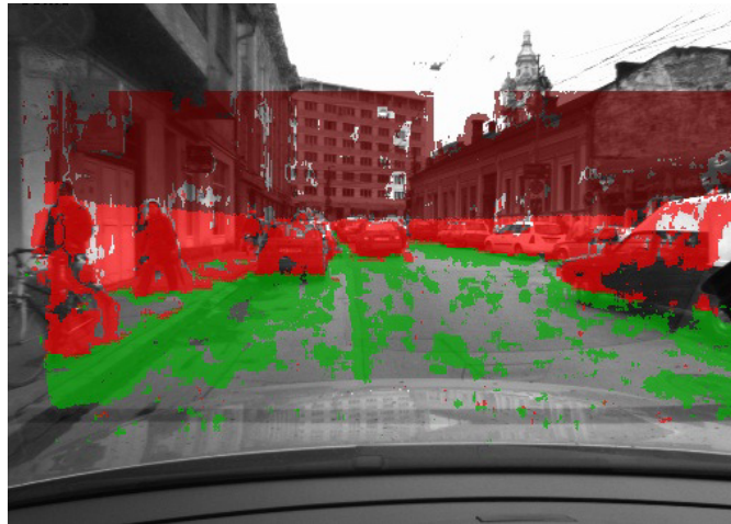
Fig. 6.1.1. Selecția punctelor 3D de interes: puncte pe sol (verzi), puncte de interes pentru detecția de obstacole (roșii), puncte mult deasupra solului (maro)
