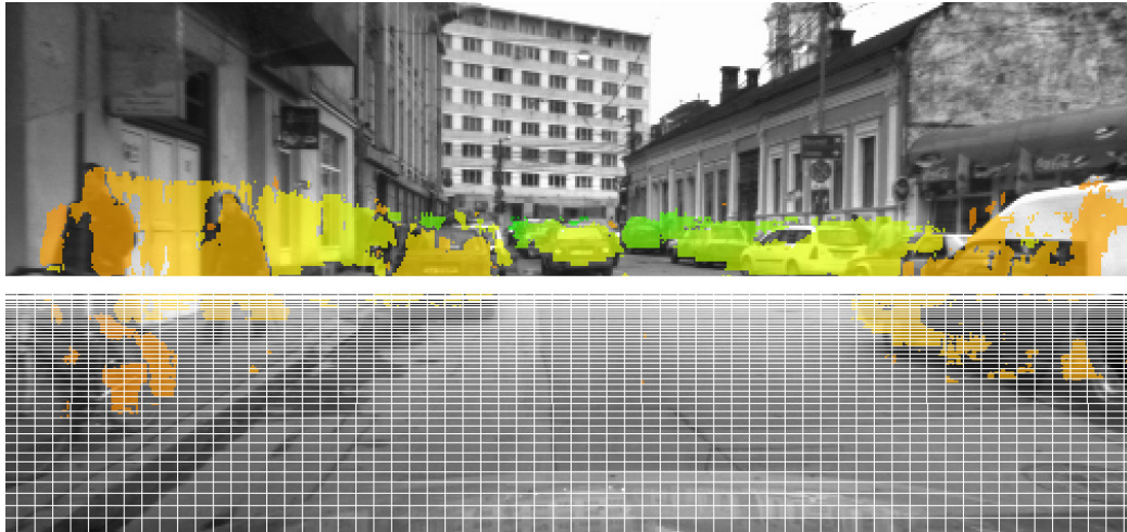
Fig. 6.1.3. Reproiecția în imagine a spațiului comprimat
