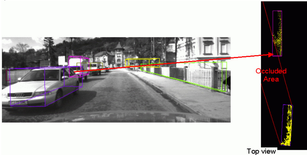
Fig. 6.3.11. Fragmentarea nu este necesară: obstacolul din spate este parțial ocluzat de obstacolul din față, provocând o formă necuboidală a reconstrucției obstacolului din spate
