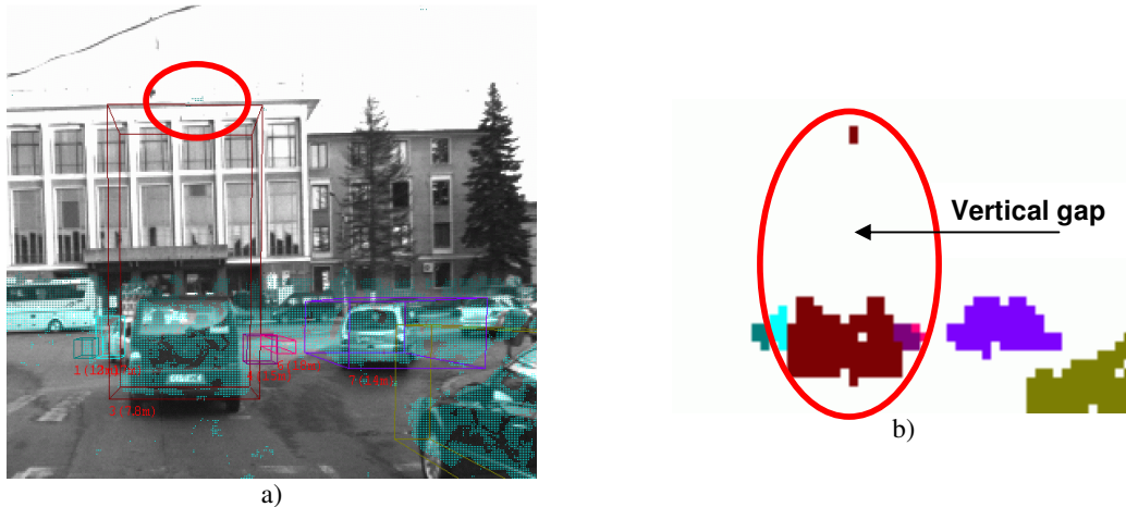
Fig. 6.2.9. a) Încă un exemplu în care obstacolul detectat este mai înalt decât cel real, din cauza unor puncte reconstruite greșit, b) imaginea perspectivă comprimată și porțiunea verticală fără celule
