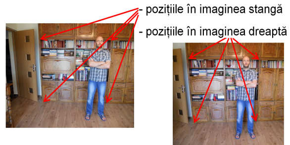
Fig. 3.1.5. Calibrarea extrinsecilor (coordonatele 3D măsurate manual)
