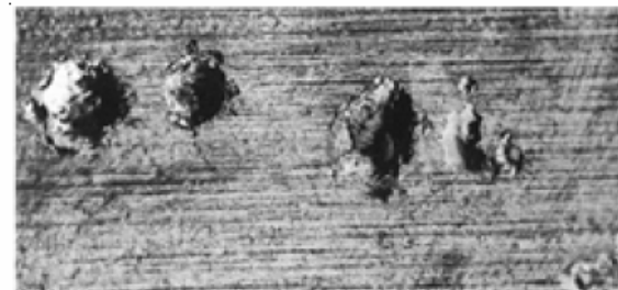
Modul in care caile de rulare ale bilelor sunt afectate
