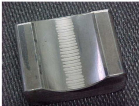
Modul in care caile de rulare ale bilelor sunt afectate
