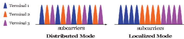
Fig. 26. Tipuri de alocare FDMA-OFDM (din Myung), D=3
