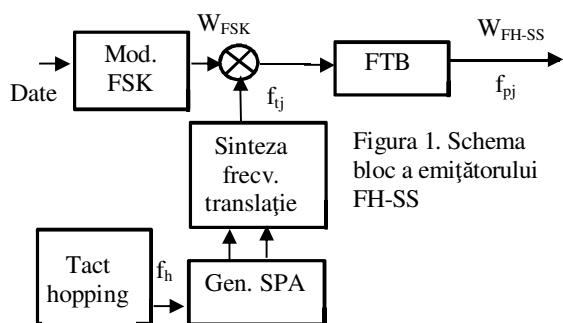
Figura 1. Schema bloc a emițătorului FH-SS
