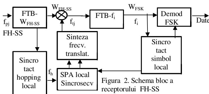
Figura 2. Schema bloc a receptorului FH-SS
