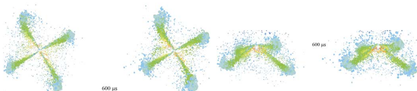
Fig. 2.4. Corelarea parametrilor procesului de injecție cu forma camerei de ardere.
