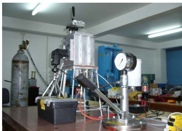
Fig. 2.5. Standul experimenta pentru studiul procesului de injectie: 1 – butelie cu gaz inert ( N_2 ), 2 – supapă de reglare a presiunii, 3 – furtun de înaltă presiune, 4 – conductă de combustibil, 5 – robinet de presurizare, 6 – robinet de purjare, 7 – injector electromagnetic, 8 – cameră de presiune, 9 – bliț, 10 – aparat foto, 11 – senzor de presiune, 12 – calculator portabil, 13 – unitate de sincronizare, 14 – pompă manuală de combustibil.
