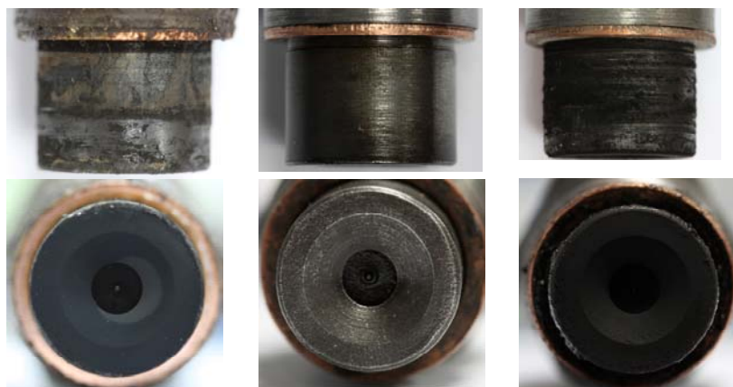
Fig. 3.12. Depunerile pe injectoare: După alimentarea cu motorină; Injectoare curățate. După alimentarea cu B25M70E5.
