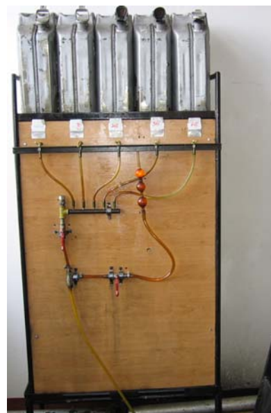
Fig. 3.2. Blocul rezervoarelor de combustibili.
