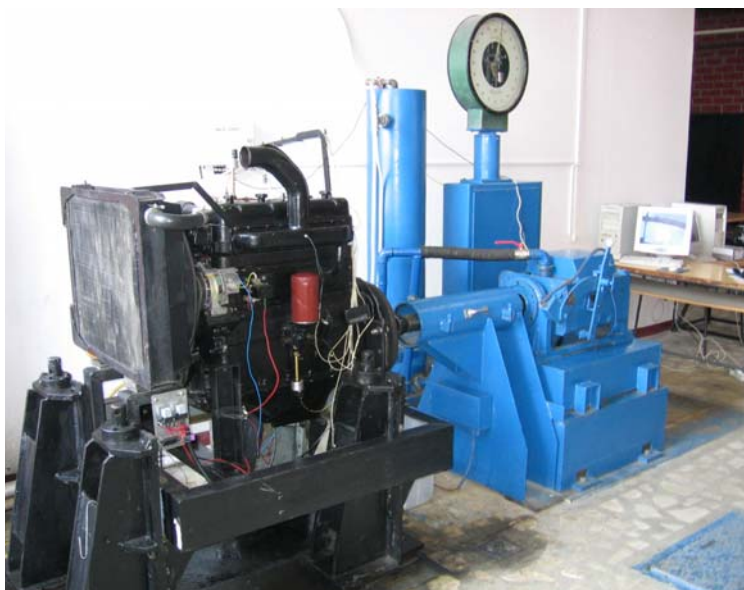
Fig. 3.1. Standul experimental echipat cu motorul D-2402.000 (foto – laboratorul de Biocombustibili – Catedra: Autovehicule Rutiere și Mașini Agricole a Facultății de Mecanică din cadrul UTC-N).
