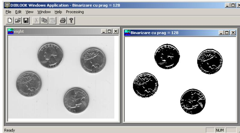
Fig. 2.4 Thresholding
