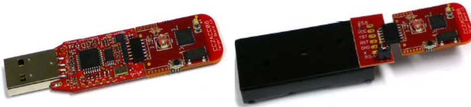
Figura 2 Sistemul de dezvoltare eZ430-RF2480
