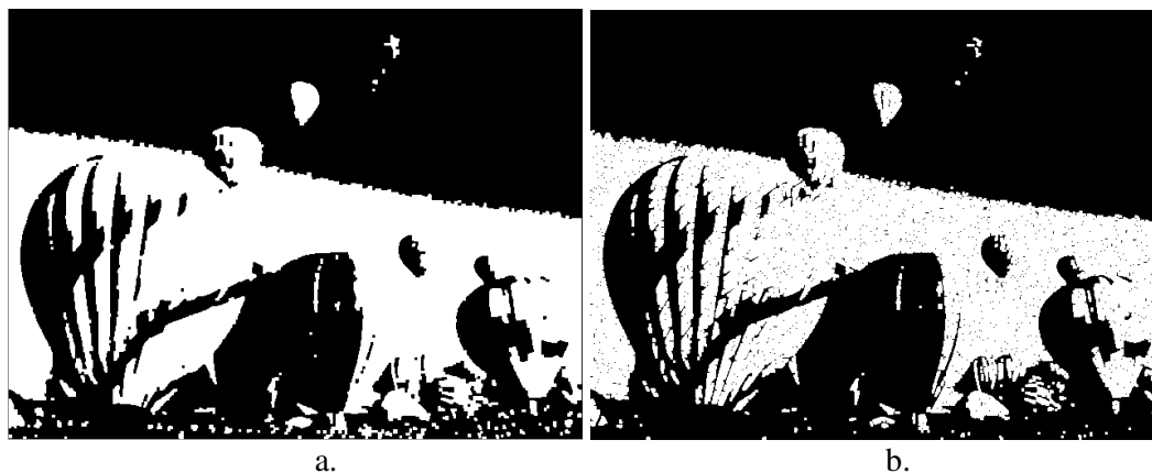
Fig. 7.8 Rezultatul deschiderii (a) și al închiderii (b) aplicată pe imaginea originală, din Fig. 7.5a (obiect = negru / fundal = alb).
