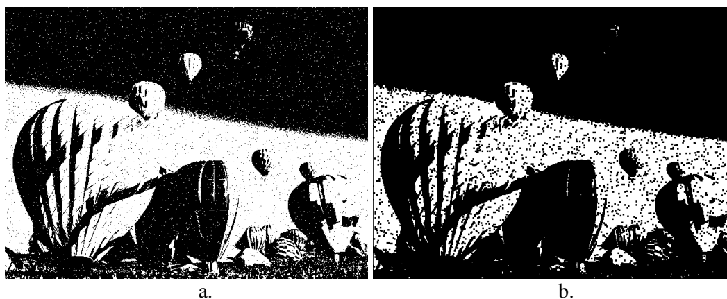
Fig. 7.3 Exemplu de dilatare (obiect = negru / fundal = alb): a. Imaginea originală A; b. Imaginea rezultată în urma operației: A \oplus B
