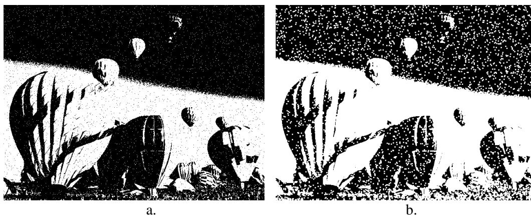
Fig. 7.5 Exemplu de eroziune (obiect = negru / fundal = alb): a. Imaginea originală A; b. Imaginea rezultat: A \ominus B
