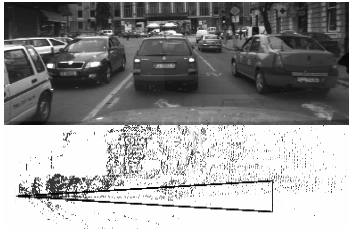
Fig. 5.20. O scenă complexă, de trafic urban, și vederea din lateral a punctelor 3D. Se evidențiază domeniul de valori pentru unghiul de aplecare.
