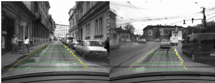
Fig. 5.17. Multiple trăsături de tip zgomot pe suprafața drumului, și vizibilitate slabă.
