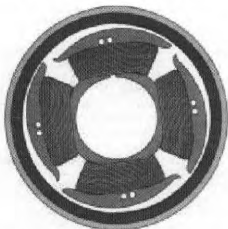
5. ábra A kefenélküli egyenáramú motor keresztmetszete
