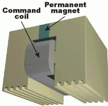
Fig. 1. The mover module
