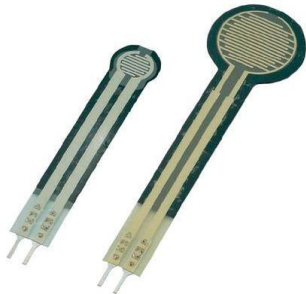
Senzor de presiune rezistiv (10 g ... 10 kg; 3 kΩ ... 2 MΩ) Sursa: www.germanelectronics.ro
