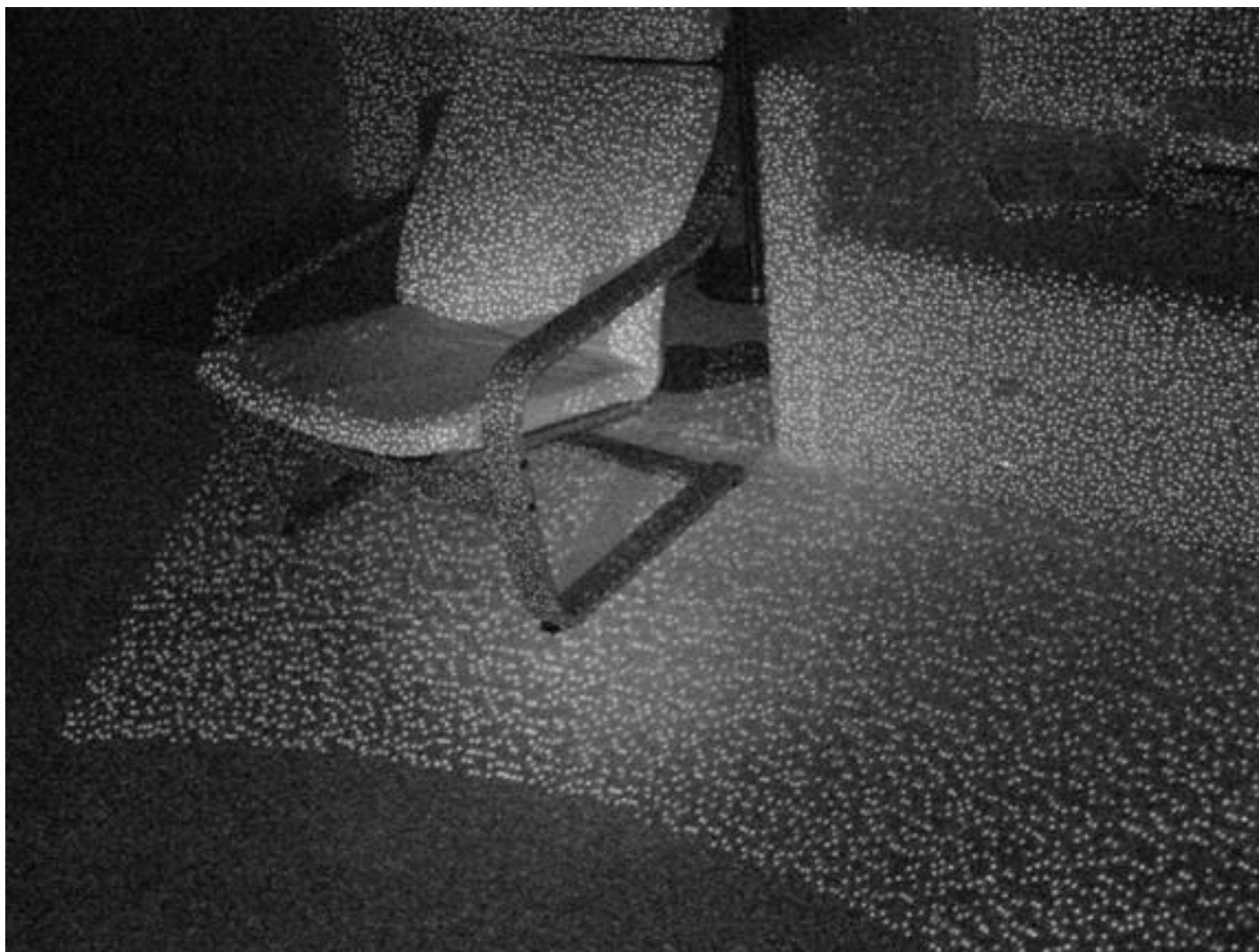
Fig. 8.2. Șablonul de puncte (pete/pistrui/„ spekles ”) proiectat pe scenă în cazul unui senzor de adâncime cu lumină structurată.
