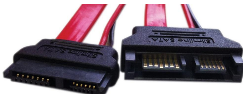
Figura 7.3. Conectorii mini-SATA combo ai unui cablu SATA.
