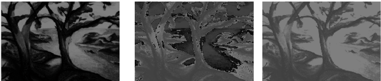
Fig2. a) Imaginea originală pe nivele de gri; b) Influența operației modulo 2^n ; c) Influența saturării.
