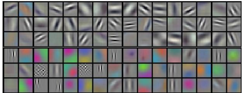
Exemple de filtre învățate de primul nivel al unei rețele neuronale convoluționale
