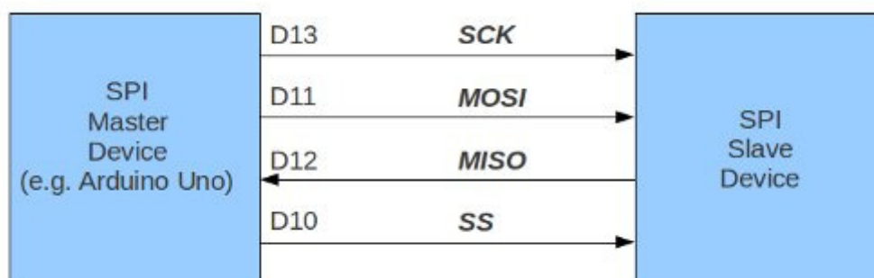
Figura 8.1 Comunicația SPI cu un singur circuit slave [12]
