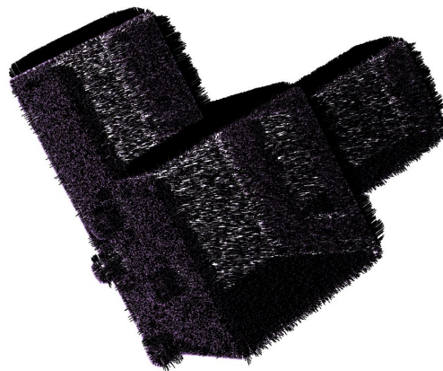
Fig. 5 Calcul de normale multiscalare pe suprafață 3D din nor de puncte
